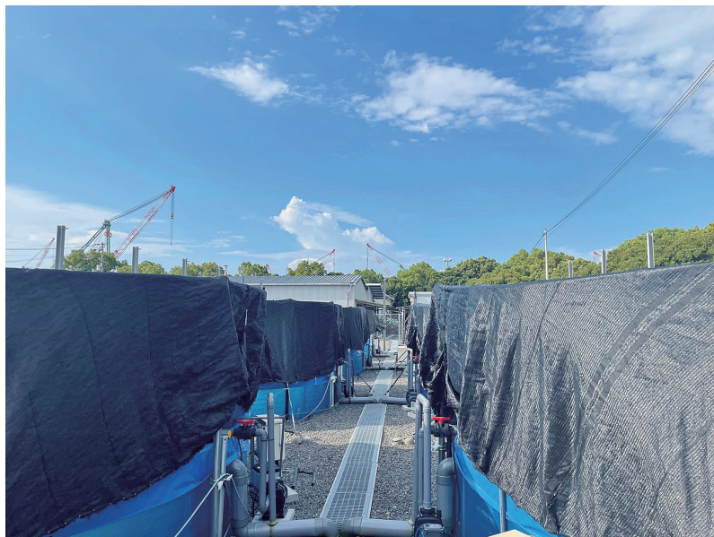
写真1 サーモンは光や音に敏感なため生簀は遮光シートに覆われる
