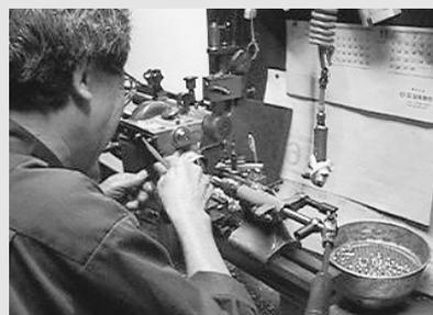
汎用旋盤による精密部品製造
