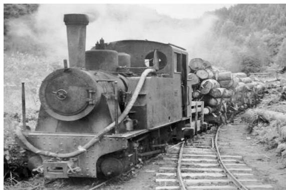
津軽森林鉄道の運材状況（雨宮式機関車）
